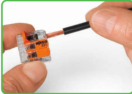
Podłączanie przewodów: otworzyć zacisk poprzez podniesienie dźwigni i wprowadzić przewód.
